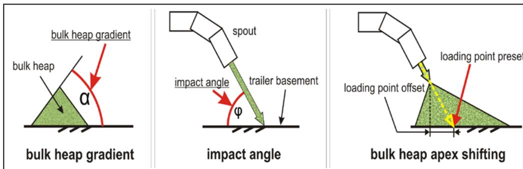
Figure 4: Bulk heap parameter definition
